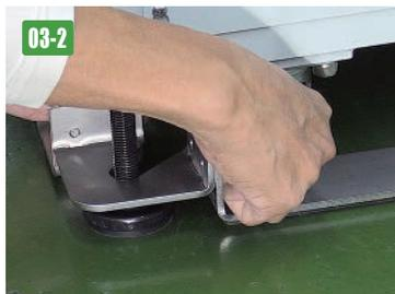
■ 高さが決まったら、ボルトをきつく締め、金具を固定。
