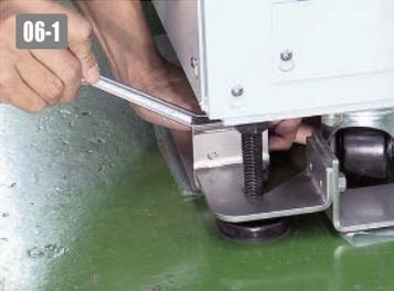
■ N-グリップを設備よりはみ出さないように設置したら、金具のボルトを本締めします。本締めにはトルクレンチを使用する場合は、12.5N・m(ニュートンメートル)で締めてください。
