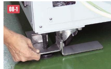
■ 最後にN-グリップが固定されているのを確認し、取付けは完了です。※設置後、数日で粘着力が上昇します。
