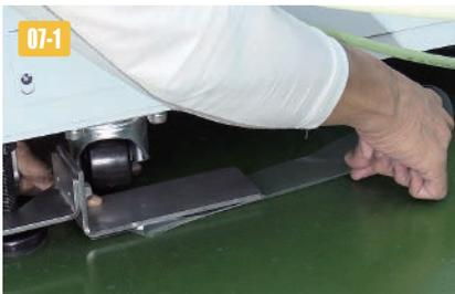
■ 本締め後、N-グリップの位置がずれないように固定しながら施工フィルムを抜き取り、耐震マットを床に貼り付けます。
