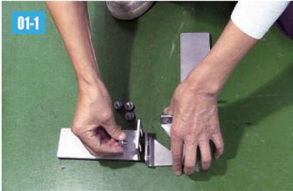
■ 取付けにあたり、まずはパーツの仮組みから始めます。仮組みは手で簡単に行えます
