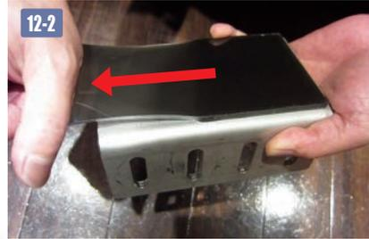
■ある程度剥がれたら、水平方向に引っ張って剥がします。剥がした直後は、耐震マットは伸びていますが、徐々に元の形に戻ります。耐震金具を外した時、マットが床面についている場合もあります。床面についている場合も同じように、水平に引っ張って剥がして下さい。
