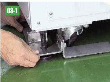
■ 仮組みができたらアジャスターに取り付け、高さを再度調整します。
