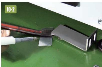
■ 水を吹きかけゲルの粘着力を弱めます。そのままゆっくり金具を持ち上げ床から剥がします。これで取外しは完了です。
